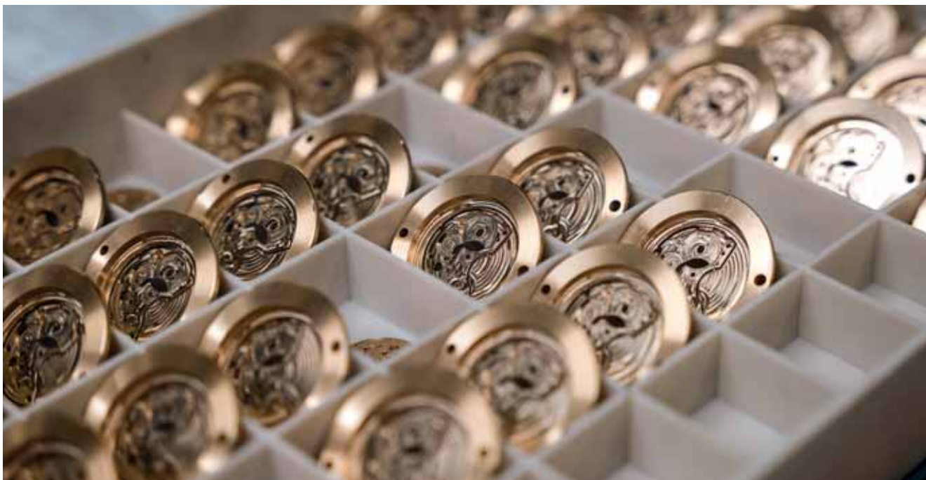
MOSAZNÉ ZÁKLADNY KALIBRU PRIM připravené k montáži – přesně opracované díly, ze kterých vznikne mechanický strojček.
